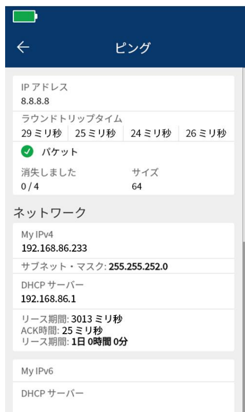
IP ピングが LinkIQ のトラブルシューティングおよび接続性テスト機能を拡張
