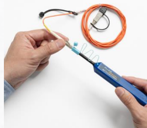
光ファイバー端面のクリーニング例
