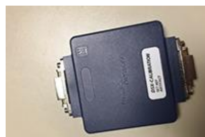
図 3 - 当社のサービス・センターで使用される 17 台のメタル・ケーブル校正アーティファクトのうちの 1 台。プラスチック製のシェルで保護されています。
